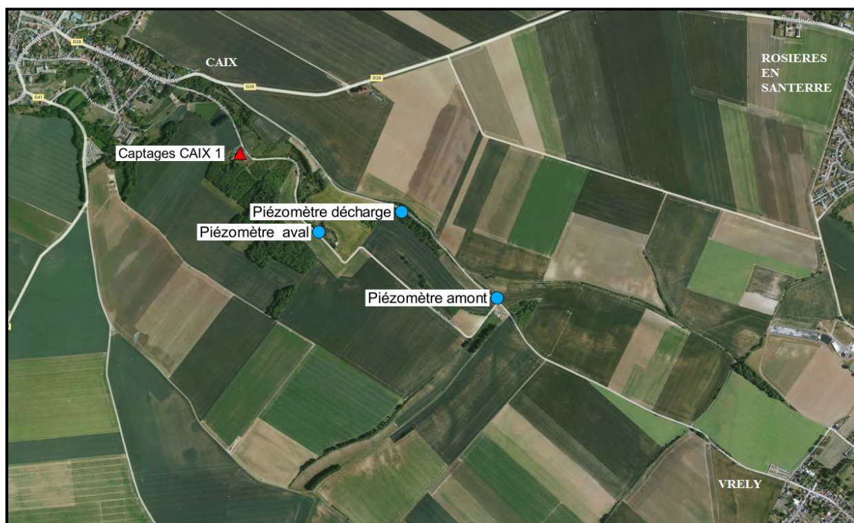
Emplacement des piézomètres autour de la décharge de Caix
